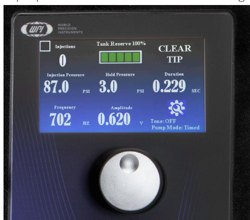
Fig. 24—Touch the Frequency parameter or the Amplitude parameter and rotate the knob.
